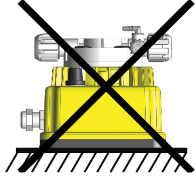
Şekil 6 Pompa Yanlış Montaj Pozisyonu
