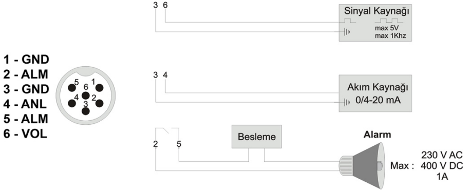
Şekil 23 Harici Bağlantı Soket Detayı
